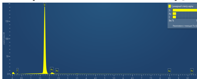
SEM spectrum p-Si<Au>
